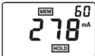
2. Para acessar os registros armazenados na memória, basta pressionar a tecla **HOLD** por 3 segundos. Pode ser armazenado até 99 registros na memória interna do instrumento. Quando a memória estiver cheia, a indicação "**MEM**" aparecerá no display.
