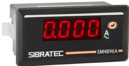
O amperímetro modelo SM4896A SIBRATEC faz parte de uma nova geração de medidores inteligentes desenvolvidos para aplicações onde se necessita de ótima precisão, facilidade de manuseio e baixo custo. Ele realiza a medição de corrente em um sistema monofásico de corrente alternada de forma indireta (utilizando transformador de corrente x/5). Principais características:
