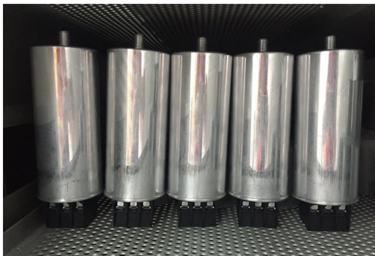
Figura 3: Teste de estanqueidade
