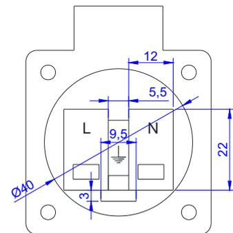
\* O modelo Tomada Padrão Brasileiro Para Trilho DIN 2P+T 20A é a tomada embutida em uma caixa plástica modelo Bx1, com dimensões 67 x 65x 65 (Altura x Largura x Profundidade).
