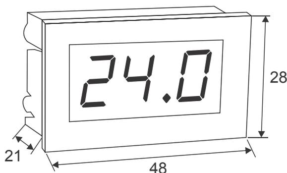
O voltímetro digital da linha TX deve ser aplicado somente nas medições de corrente contínua. Medições como baterias de carro ou moto, pilhas, fontes e outras.
