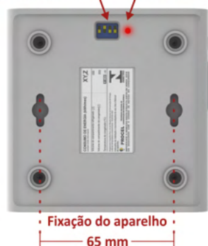
Figura 1 - Sinais luminosos e cartão SD Card
