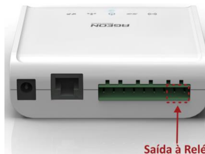
Figura 30 - Localização do borne Saída à Relé
