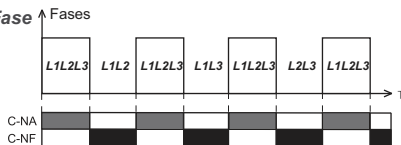
Falta de Fase
