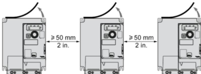
Para operação a temperatura ambiente acima de  $50^\circ\text{C}$  ( $122^\circ\text{F}$ )
