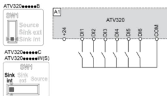
Comutador SW1 definido para a posição “Coletor ext” e utilização de uma alimentação externa para as DIs.
